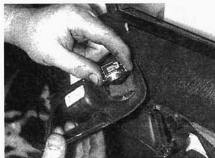
Рис. 19.8,в. ... затем отпустите крепления и извлеките динамик
