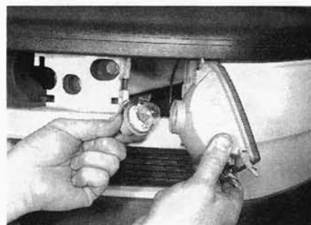
Рис. 5.13. Поверните патрон против часовой стрелки и извлеките его из фонаря
