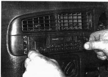
Рис. 18.3,а. На автомобилях, изготовленных до 1994 г.: вставьте приспособления для снятия ...
