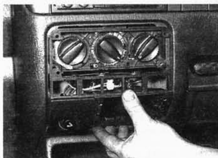
Рис. 11.6,а. ... затем извлеките панель выключателей из лицевой панели
