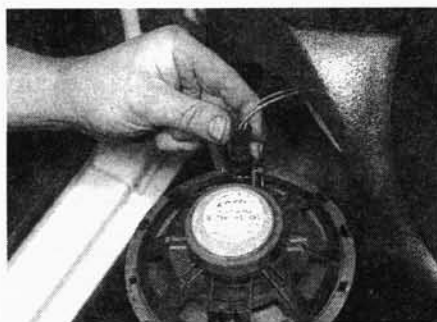
Рис. 19.5,б. ... и разъедините разъем электропроводки
