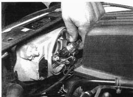
Рис. 5.4,б. ... и извлеките лампу из фары
