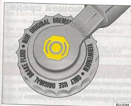
Илл. 131 В моторном отсеке: крышка бачка с тормозной жидкостью.
