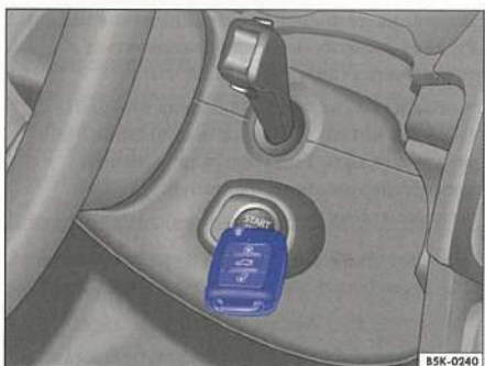
Илл. 118 Аварийный пуск на автомобилях с KESSY.
