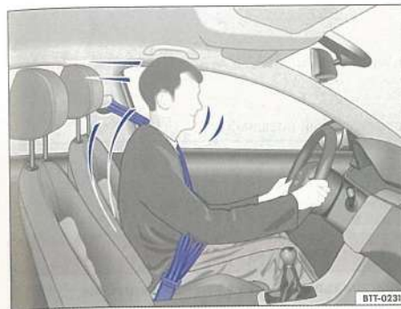
Илл. 52 При резком торможении пристёгнутого водителя удерживает ремень.
