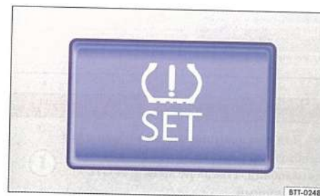
Илл. 146 В центральной консоли: Клавиша сигнализатора падения давления в шинах.
