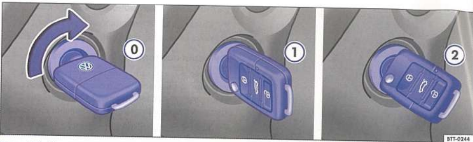
Илл. 116 Положения ключа зажигания.
