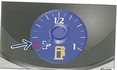
Илл. 152 В комбинация приборов: Указатель запаса топлива (бензин и дизельное топливо).
