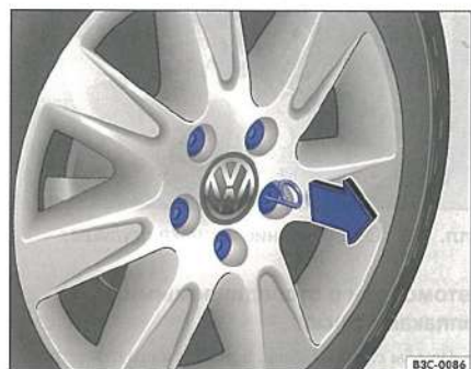
Илл. 190 Снятие колпачков колёсных болтов.
