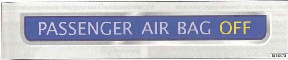
Илл. 59 Контрольная лампа отключенной фронтальной подушки безопасности переднего пассажира в передней панели.
