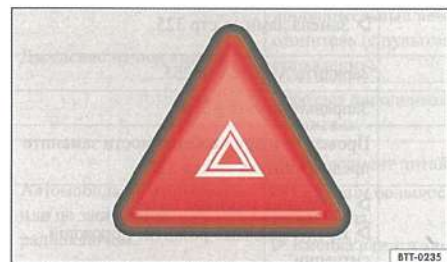
Илл. 175 В центре передней панели: выключатель аварийной световой сигнализации.
