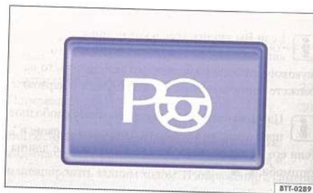
Илл. 138 В центральной консоли; клавиша включения парковочного автопилота.
