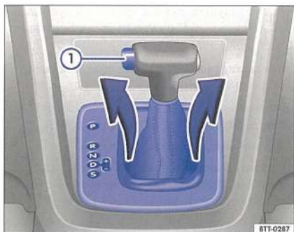
Илл. 183 Снять накладку кулисы переключения передач.
