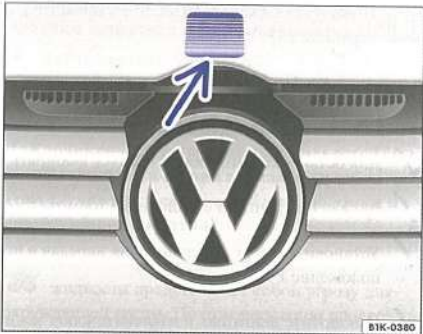
Илл. 158 Рычажок отпирания капота у решётки радиатора.
