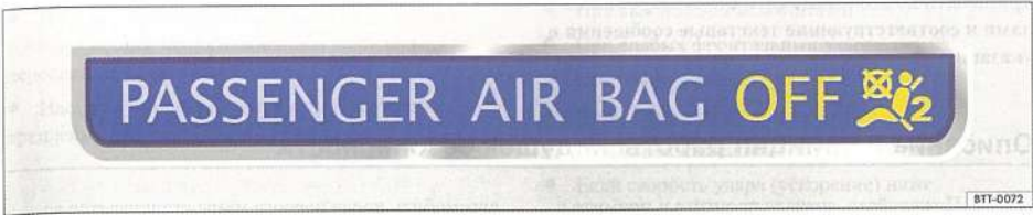
Илл. 58 Контрольная лампа отключенной фронтальной подушки безопасности переднего пассажира в передней панели.
