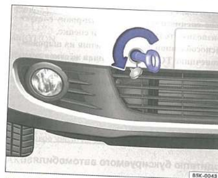
Илл. 212 В переднем бампере справа: вворачивание буксирной проушины.
