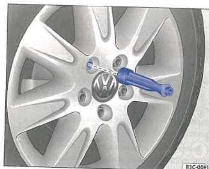
Илл. 195 Замена колеса: выворачивание колёсных болтов ручкой отвёртки.
