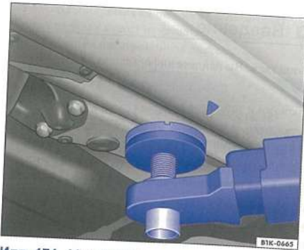
Илл. 174 Места установки захватов подъёмника сзади.
