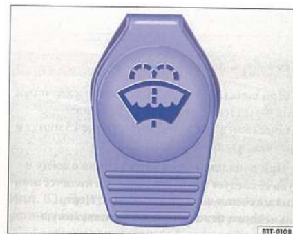
Илл. 82 Крышка бачка стеклоомывателя в моторном отсеке.
