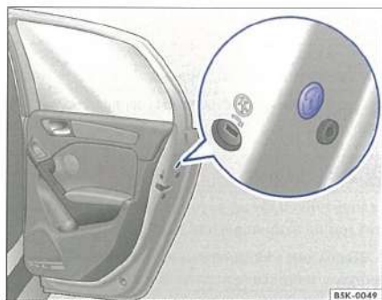
Илл. 178 На торце задней правой двери: прикрытый резиновой заглушкой аварийный замок.
