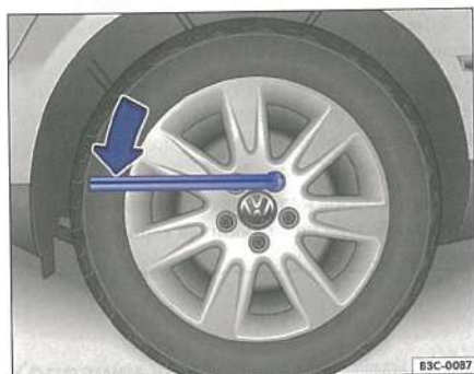
Илл. 191 Замена колеса: ослабление колёсных болтов.
