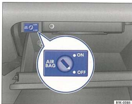
Илл. 64 В вещевом отсеке на стороне переднего пассажира: Выключатель с замком для подушки безопасности переднего пассажира.
