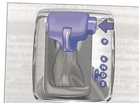
Илл. 125 Селектор АКП с блокировочной кнопкой (стрелка) автомобиля с правым рулём.
