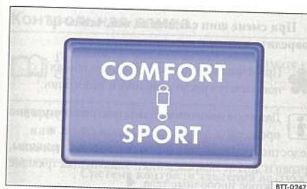
Илл. 145 В центральной консоли: клавиша адаптивной системы регулирования ходовой части.
