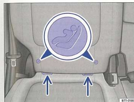
Илл. 68 Вариант 1: обозначения нижних точек крепления детского сиденья на сиденье автомобиля.
