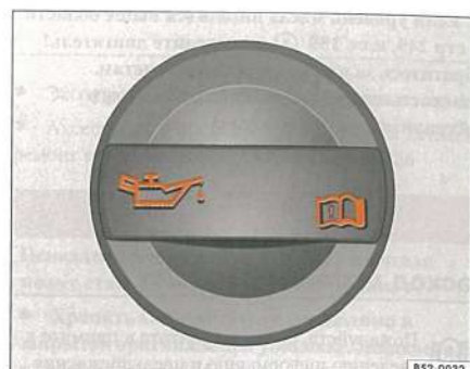
Илл. 160 В моторном отсеке: крышка маслосливной горловины.
