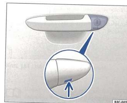
Илл. 177 Ручка двери водителя: скрытая личинка замка.
