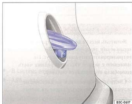
Илл. 140 Дверь/крышка багажного отсека: местонахождение камеры заднего вида.
