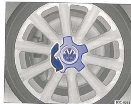
Илл. 188 Откручивание колпака ступицы.
