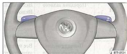
Илл. 127 Рулевое колесо с селекторами Tiptronic.
