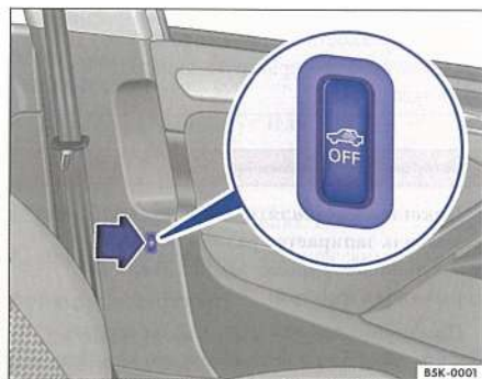
Илл. 22 Сбоку от сиденья водителя: кнопка отключения систем охраны салона и защиты от буксировки.
