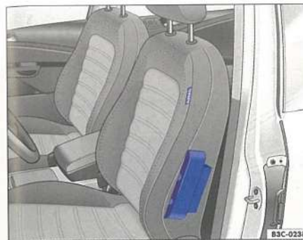
Илл. 65 Боковина переднего сиденья: место установки боковой подушки безопасности.
