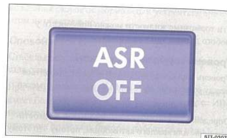
Илл. 130 В центральной консоли: Клавиша для ручного отключения и включения функции ASR (автомобили без ESP).
