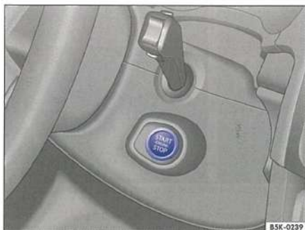
Илл. 117 Система KESSY: пусковая кнопка.
