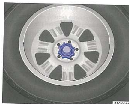
Илл. 171 В багажном пространстве: Маховичок крепления запасного колеса.
