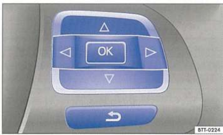
Илл. 11 Правая сторона многофункционального рулевого колеса: элементы управления меню в комбинации приборов.
