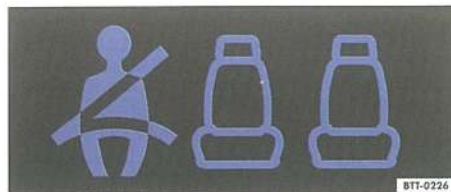
Илл. 47 Индикация статуса ремня в комбинации приборов сзади.
