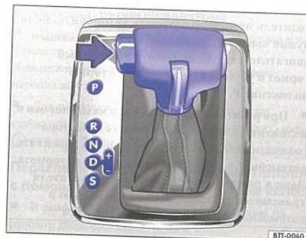
Илл. 124 Селектор АКП с блокировочной кнопкой (стрелка) автомобиля с левым рулём.
