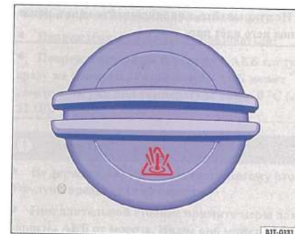
Илл. 163 В моторном отсеке: крышка расширительного бачка системы охлаждения.
