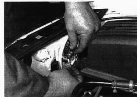
Рис. 5.9,б. ... и извлеките лампу, нажав на нее и повернув против часовой стрелки
