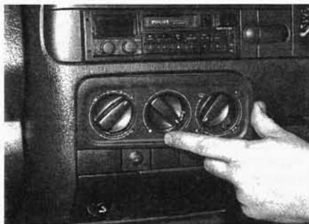
Рис. 11.2,а. Снимите окантовку ручек управления отопителем ...
