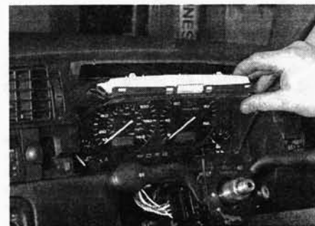
Рис. 9.5,б. ... затем извлеките приборный щиток из лицевой панели ...
