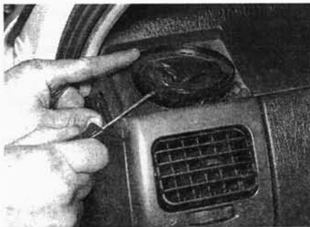
Рис. 19.2. ... и осторожно подцепите и извлеките передний верхний динамик
