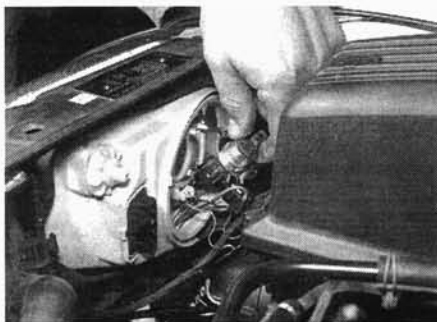
Рис. 5.4,б. ... и извлеките лампу из фары
