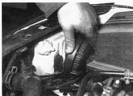
Рис. 5.2. Снимите крышку (показана круглая крышка) в задней части фары ...
