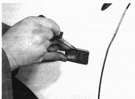
Рис. 5.15. Отделите верхний край фонаря повторителя от крыла с помощью отвертки
