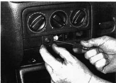
Рис. 4.11. Извлечение выключателя обогрева заднего окна
