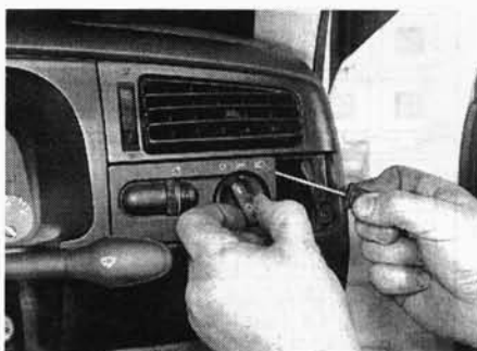
Рис. 4.7, а. ... затем нажмите на фиксатор и извлеките выключатель в сборе ...
