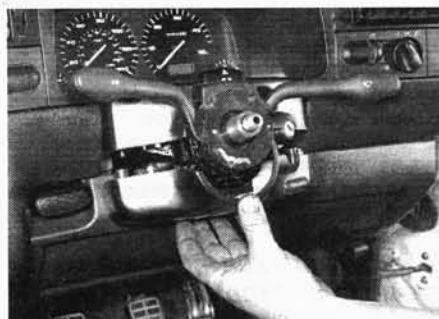
Рис. 4.3. Выверните винты и снимите верхний и нижний кожухи рулевой колонки
