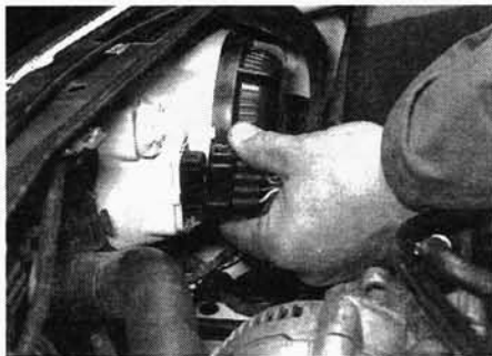
Рис. 7.2. Разъединение разъема электропроводки фары
