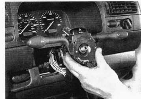
Рис. 4.4,б. ... затем снимите комбинированный выключатель
