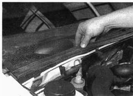
Рис. 14.3. Снимите резиновое уплотнение с перегородки моторного отделения
