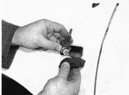
Рис. 5.16. Поверните патрон против часовой стрелки и извлеките его из фонаря
