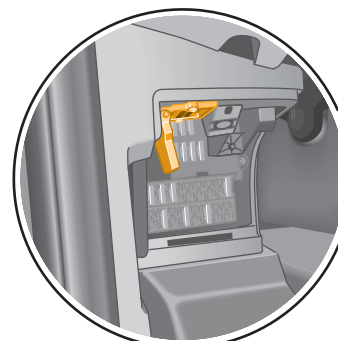
штекерный разъем (T16) диагностический вывод, у левой стойки А
