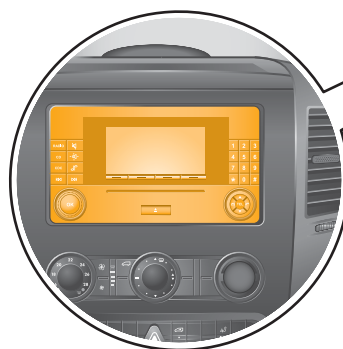
блок управления с дисплеем магнитолы и навигационной системы J503/магнитола R, в центральной приборной панели
