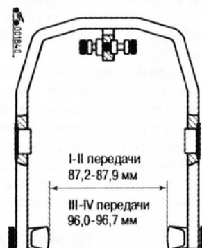
Рис. 5.35. Измерение расстояния между наконечниками вилок включения передач
