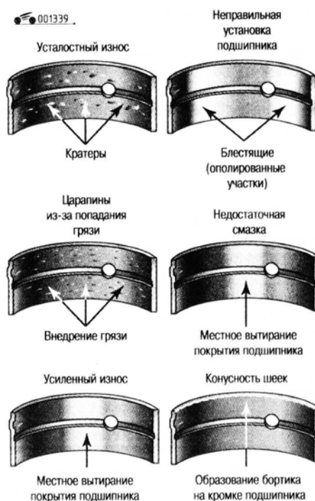
Рис. 4.38. Виды повреждений вкладышей
