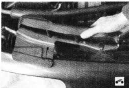
7. Снимите воздухозаборник воздушного фильтра.
