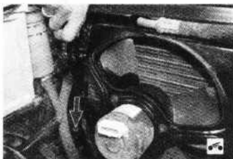
5. Выверните два болта крепления кожуха электроventильатора к кронштейну радиатора с левой стороны.
