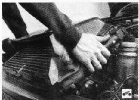
5. Если автомобиль оснащен системой кондиционирования, осторожно приподнимите радиаторы систем охлаждения и кондиционирования и положите, как показано на фото.
