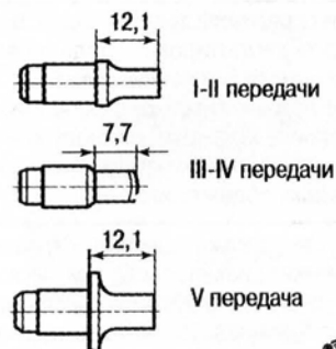
Рис. 5.34. Размеры наконечников вилок включения передач
